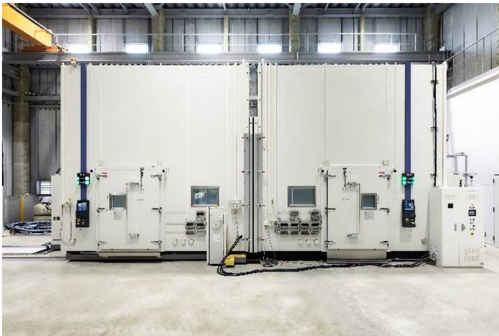
恒温(恒湿)室 建材用試験室
